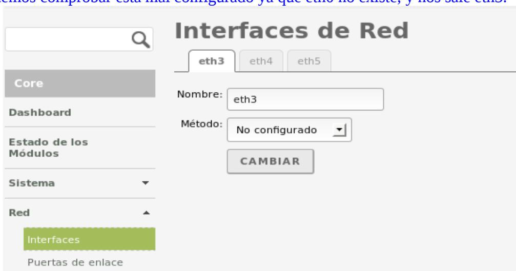
Para solucionarlo solo tenemos que cambiar el nombre a "eth0" y en método poner "DHCP", quedando así:
